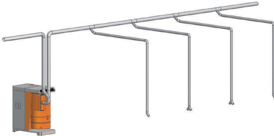
Um die verschmutzte Luft vom Ort der Erfassung zur Absaug- und Filteranlage zu transportieren wird ein Rohrleitungssystem verwendet, dass nach Ihren Wünschen entworfen und montiert wird. Das komplette System ist sendzimir verzinkt und besteht aus Rohren, Schellen, Anschlussstücken, T-Stücken, Reduzierungen und allen anderen nötigen Rohrleitungsteilen. Alle Einzelteile sind verschleißfest, da sie aus Stahl gefertigt sind.
