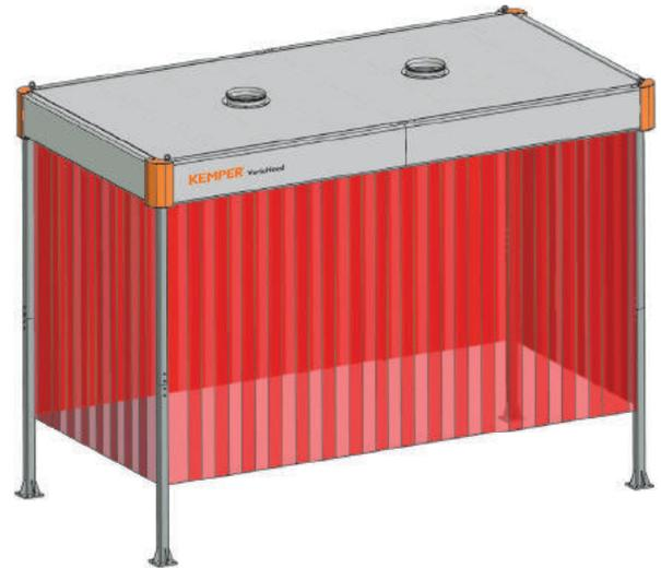
Die modulare Absaughaube VarioHood kann im Rastermaß von 450 mm x 450 mm bis zu einer maximalen Breite von 3.150 mm individuell konfiguriert werden. Dabei spielt die Länge keine Rolle. KEMPER hat bereits Hauben mit einer Länge von über 20.000 mm realisiert.
